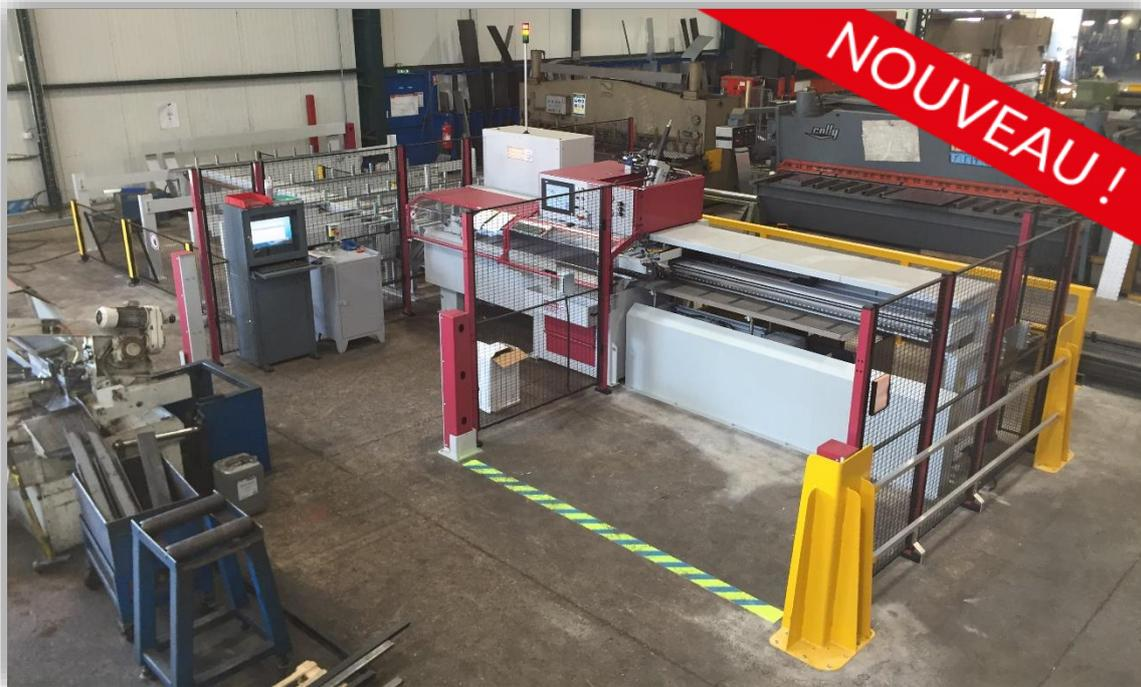
Depuis janvier 2020, nous sommes équipés d'un nouveau centre de débit automatisé. Il traite les profilés et tubes ainsi que du plein de différentes sections. Alimentation via un magasin automatique permettant le stockage de 11 barres. Système de tri pour le déchargement.
